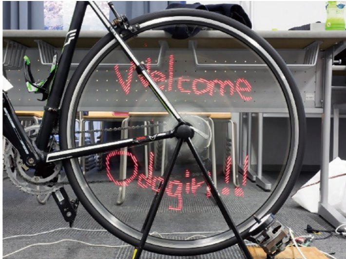
図5 ホイール装着型残像ディスプレイ。
