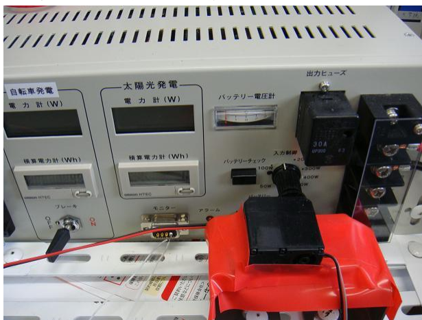
図4 WINTEX-880A 充電制御器とサーボ機構
