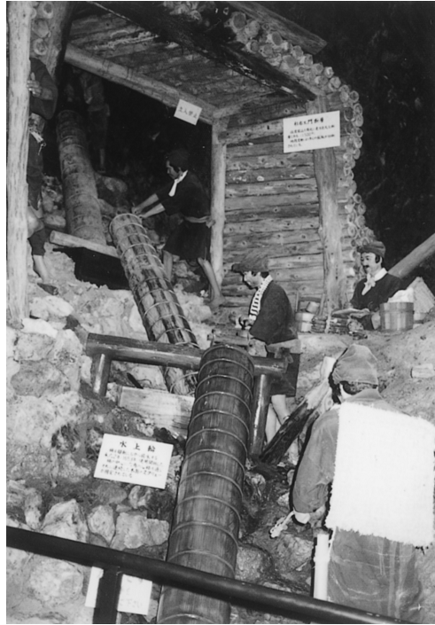
写真 4-2 佐渡鉱山の水上輪（回転させる）
