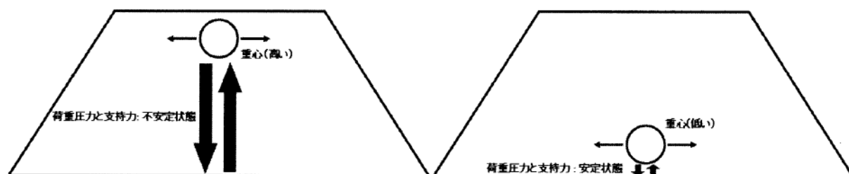
図31 中心の位置による荷重圧力と支持力の状態（筆者作成）
