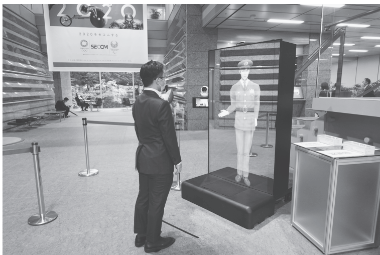
(4) 熱画像カメラで来訪者の体温チェックにあたるバーチャル警備員（セコム本社にて）
