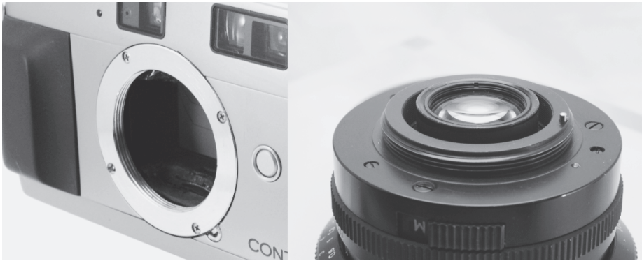
図1 ねじ込み式のスクリーマウント ボディ側にめねじ レンズ側におねじを持つ
