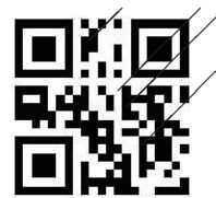
復号誤り → 春は名てめの風の映さ (4 セルがランダムノイズで反転)
